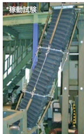
空調用 常温仕様 免震量600 口径250/250□ ×取付長1600L (本体はクロロプレンゴム製)
