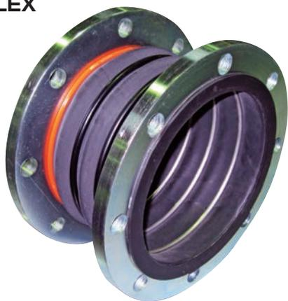
ジャバフレックスの本体にはCRゴム、フッ素樹脂内貼り品、フッ素ゴム、シリコンゴム、ウレタンゴム、ニトリルゴム、ブチルゴムなどの材料を使用。繊維で強化したこれらのゴム膜の積層によって、強度と柔軟性を兼ね備えています。また、工業用合成ゴム接着剤使用品よりも優れた耐熱性、強度を実現しています。粉粒体輸送配管、高圧ブロアー、ポンプ、FRP・塩ビ配管の熱膨張変位の吸収に活躍しています。
