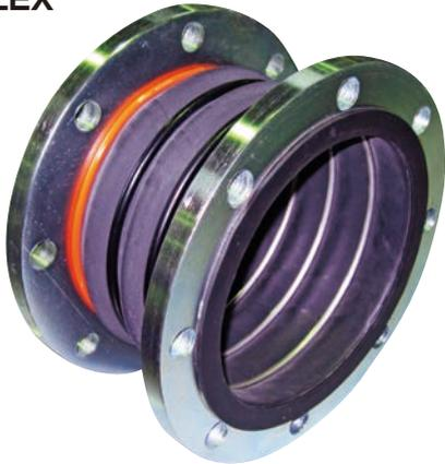
ジャバフレックスの本体にはCRゴム、フッ素樹脂内貼り品、フッ素ゴム、シリコンゴム、ウレタンゴム、ニトリルゴム、ブチルゴムなどの材料を使用。繊維で強化したこれらのゴム膜の積層によって、強度と柔軟性を兼ね備えています。また、工業用合成ゴム接着剤使用品よりも優れた耐熱性、強度を実現しています。粉粒体輸送配管、高圧ブロー、ポンプ、FRP・塩ビ配管の熱膨張変位の吸収に活躍しています。
