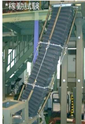
*稼動試験 空調用 常温仕様 免震量600 口径250/250□×取付長1600L (本体はクロロプレンゴム製)
