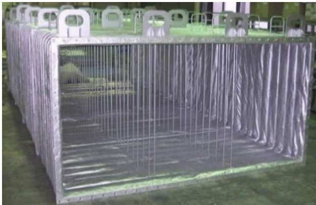
排煙用 耐熱280℃仕様 免震量660 口径2500/1250□×取付長2340L (本体はガラスクロス等の複合材)
