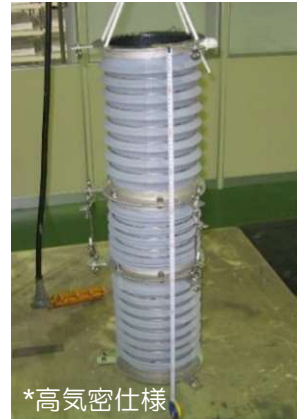
*高气密仕様 溶剤排気用 常温仕様 免震量400 口径φ200×取付長650L (本体内面はフッソゴム使用)
