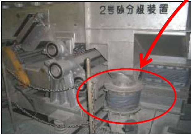
流体温度=MAX400℃ 伸縮量=軸方向±15・軸直角±15
